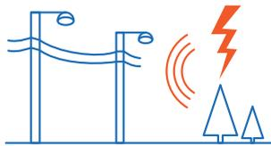
**наведённых перенапряжениях** при ударах молнии в дерево или землю на расстоянии до 1 км от линии освещения
